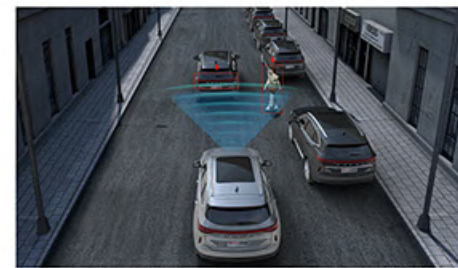
АЕВ (Система за автономно аварийно спиране с функция за разпознаване на пешеходци)
