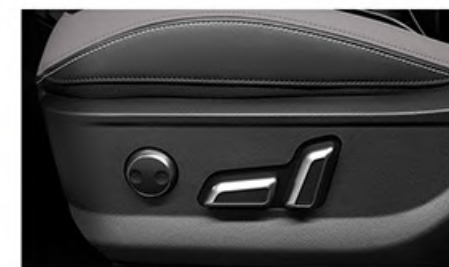
Електрическо, 8-позиционно регулиране на седалката на шофьора
