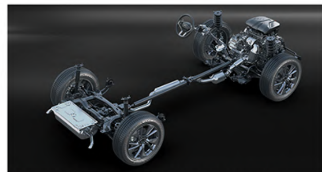
Независимо окачване, McPherson предно и мултилинк задно + 4WD
